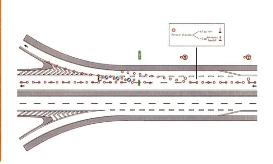
2) che durante le ore notturne ed in tutti i casi di scarsa visibilità le barriere regolamentari di testata della zona di lavoro devono essere munite di idonei apparati luminosi di colore rosso a luce fissa, così come il segnale
